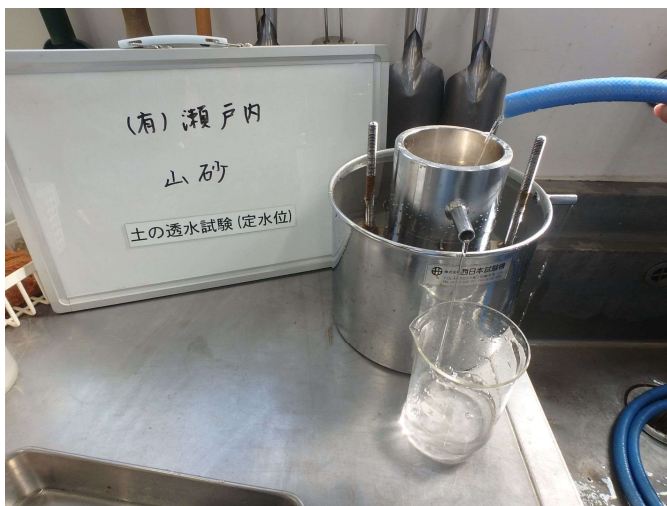
土の透水試験（定水位法）
