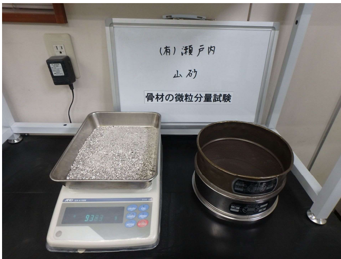
骨材の微粒分量試験
