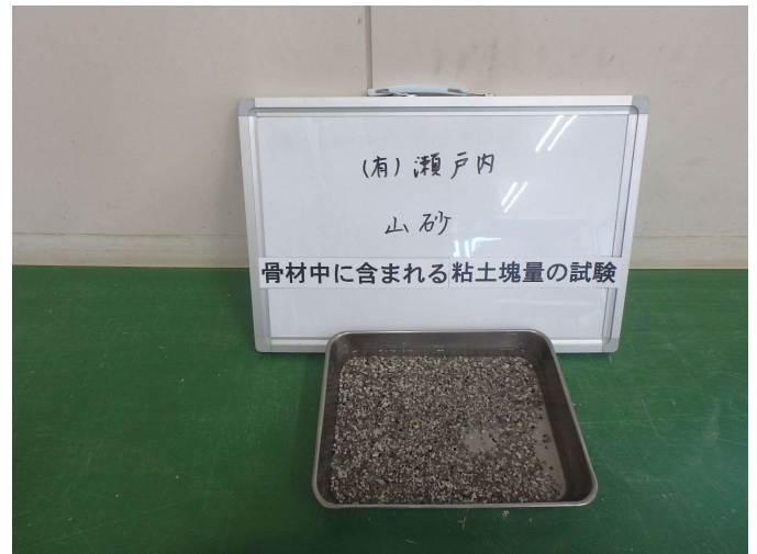
骨材中に含まれる粘土塊量の試験
