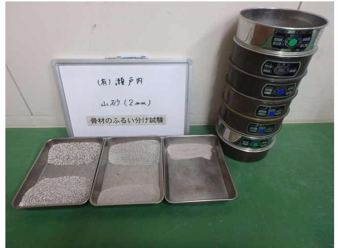
骨材のふるい分け試験
