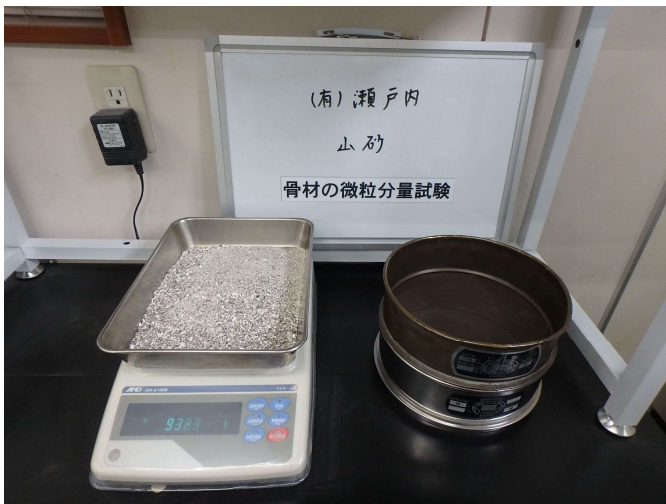
骨材の微粒分量試験
