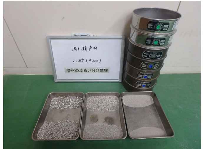
骨材のふるい分け試験
