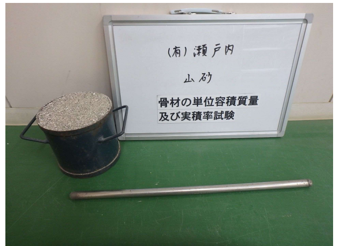
骨材の単位容積質量及び実積率試験
