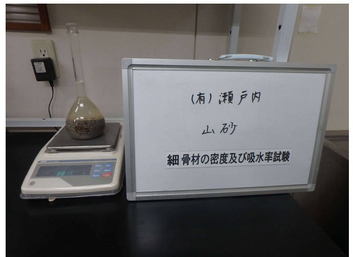
細骨材の密度及び吸水率試験
